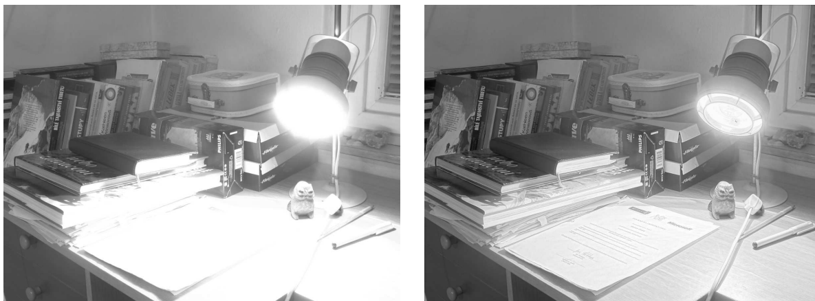
Obrázek 4.5: Obraz HDR se světelným zdrojem mapovaný globální, lineární metodou (vlevo). Stejný obraz mapovaný pomocí pokročilé lokální metody (vpravo). (Obrázky poskytl M. Čadík, ČVUT v Praze.)
