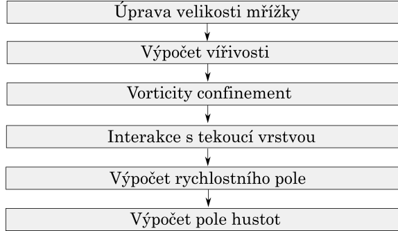
Obrázek 4.6: Podrobné schéma simulace na mřížce.
