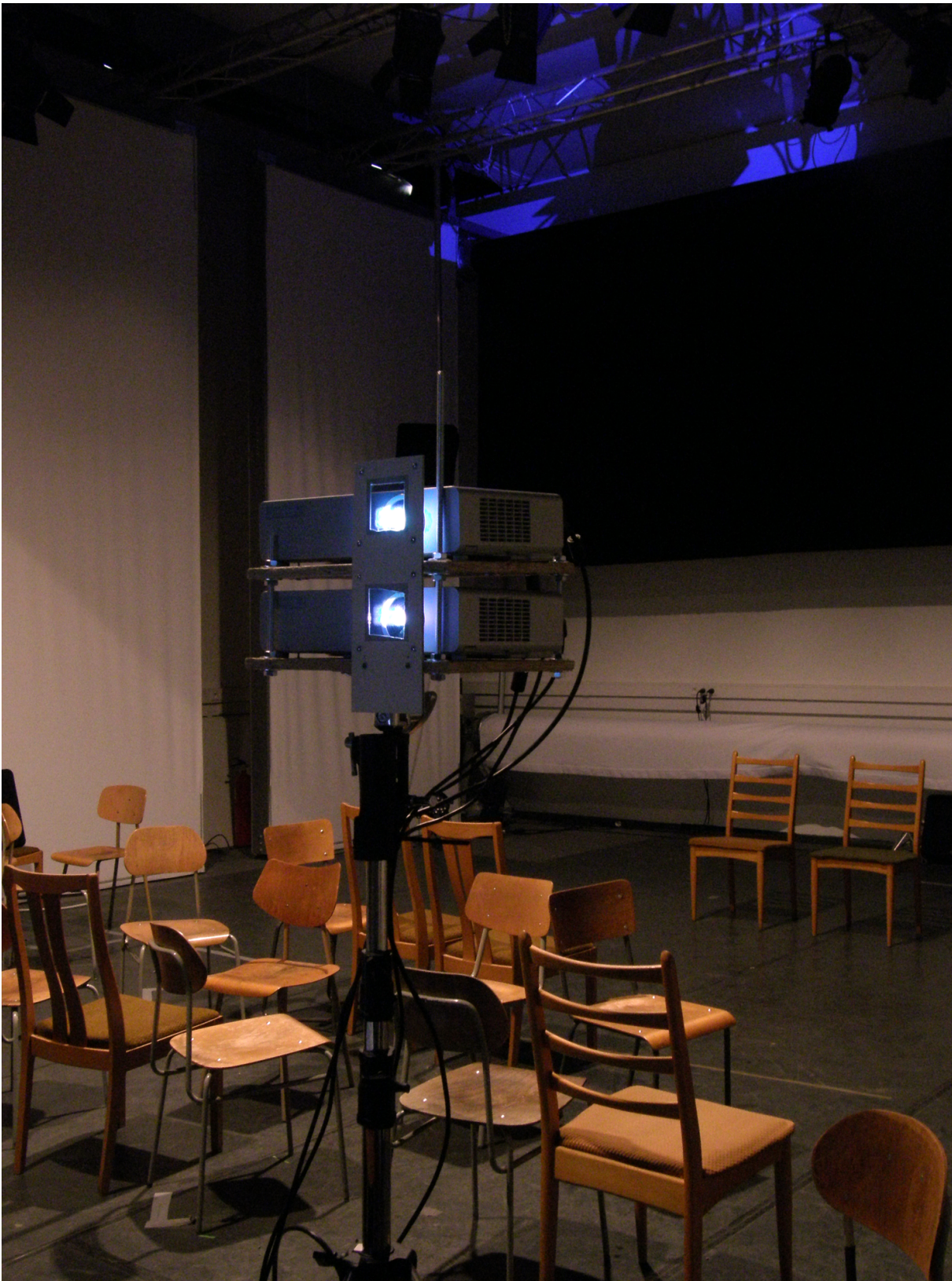
Obr. 10.3: Projektory pasivní stereoskopické prezentace v IIM. Sloužily k testovacím účelům.
