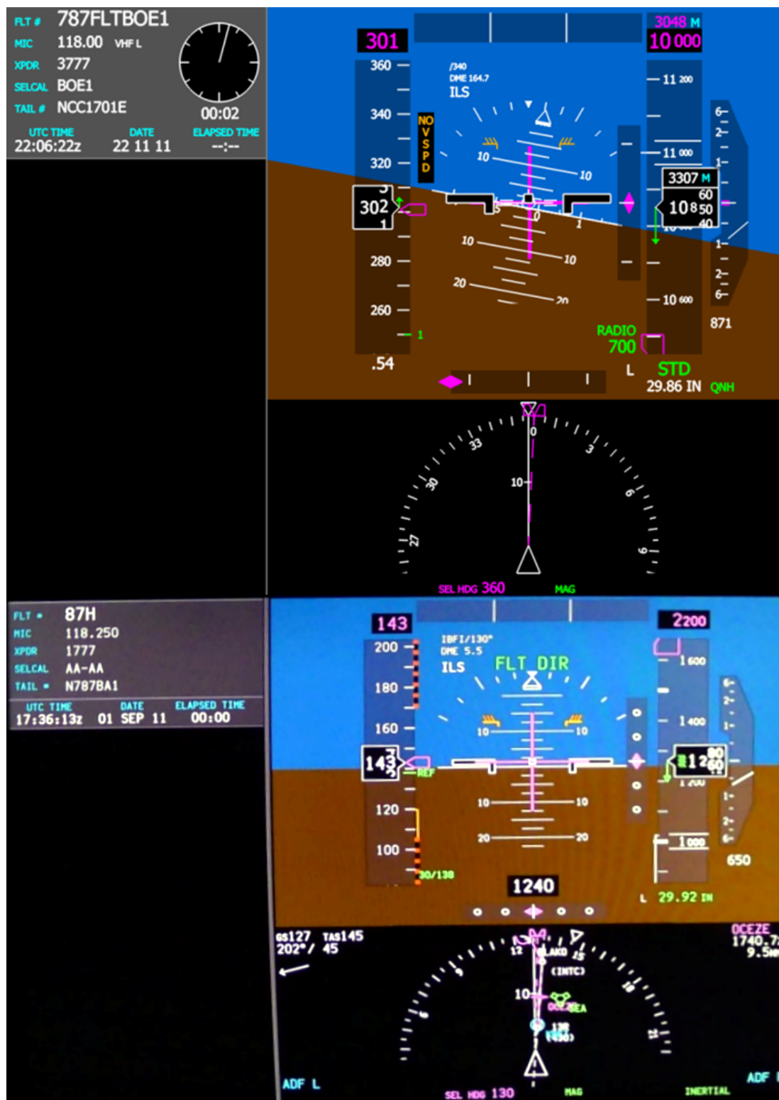
Obrázek 6.2 Porovnání vytvořeného a skutečného EFISu (nahore vytvořený EFIS, dole fotografie ze simulátoru úrovně Level D)) [26]
