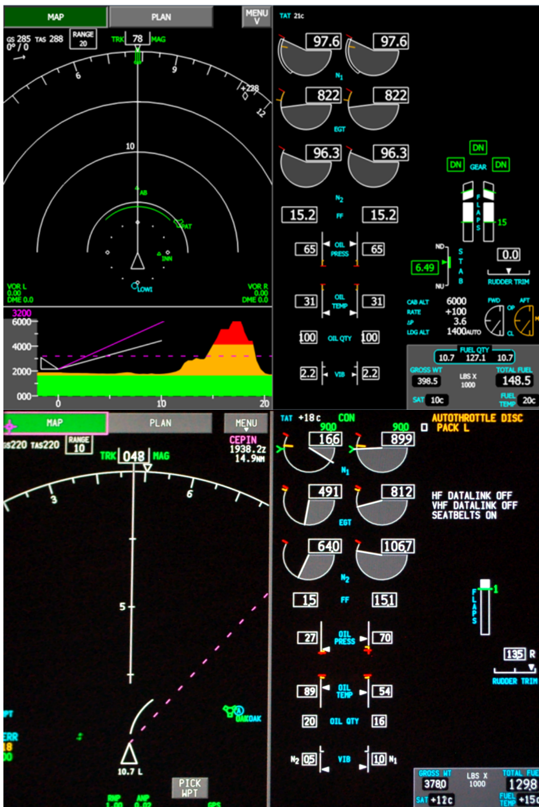
Obrázek 6.3 Porovnání vytvořeného a skutečného EFISu (nahore vytvořený EFIS, dole fotografie ze simulátoru úrovně Level D)) [26]
