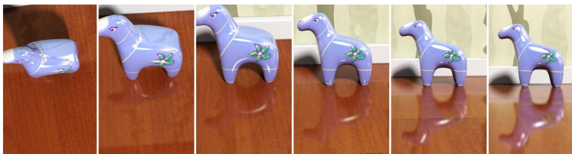
Obr 13 Ukázka nastavení závislosti úhlu pohledu na odrazu: (vlevo) úhel pohledu 0^\circ a nulový odraz. (vpravo) Úhel pohledu 90^\circ a vysoká odrazivost materiálu. [27]
