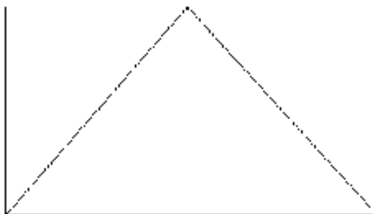
b) Ukázka lichoběžníkového, konkrétně trojúhelníkového tvaru obálky [14].
