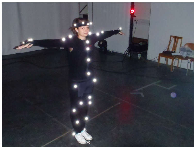
Obrázek 2.3: Optický systém motion capture s aktorem Zdroj: vlastní
