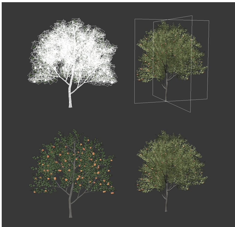
Obrázek 4.8: Příklad modelu stromu Xfrog, vlevo pomocí husté polygonální sítě (117675 polygonů), vpravo pomocí billboardového kříže (4 polygony)
