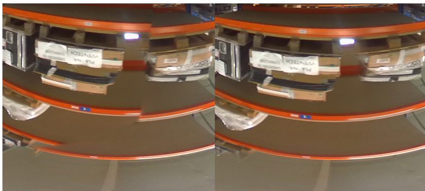
Obrázek 7.5: Napojení snímků před (vlevo) a po (vpravo) korekci
