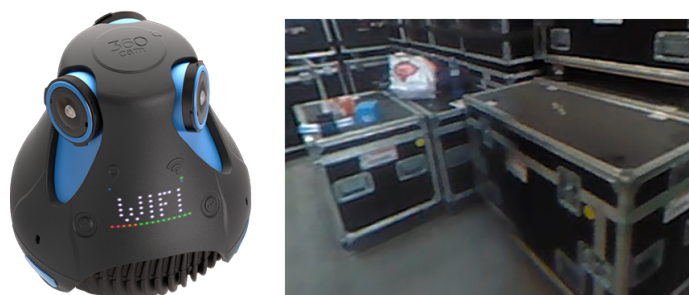
Obrázek 7.1: Kamera Giroptic a detail napojení snímků tvořící šev
