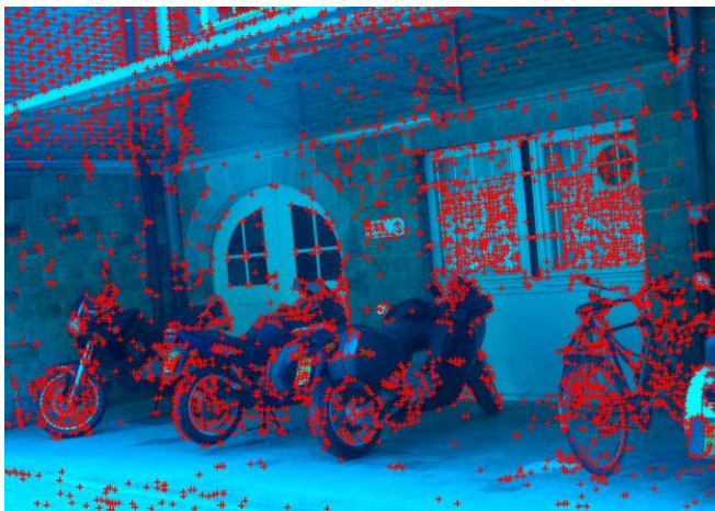
Obr. 3 Detekce význačných bodů na snímku. Obrázek získán ze zdroje [17]
