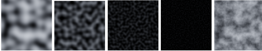
Obrázek 2.6: Sčítání šumů. Každý šum je vzorkován s dvakrát větší frekvencí než ten předchozí (zleva) a má dvakrát menší amplitudu. Výsledný šum je zobrazen vpravo.
