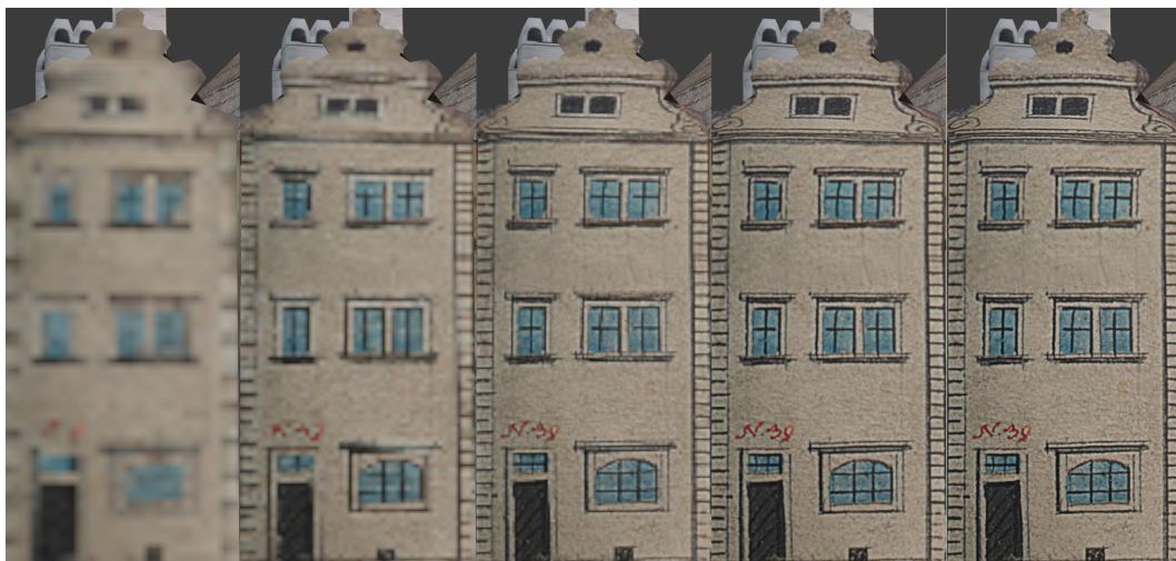
Obrázek 4.4. Porovnání textur různých rozlišení. Rozlišení textur zleva: 1K, 2K, 4K, 8K a originální textura.
