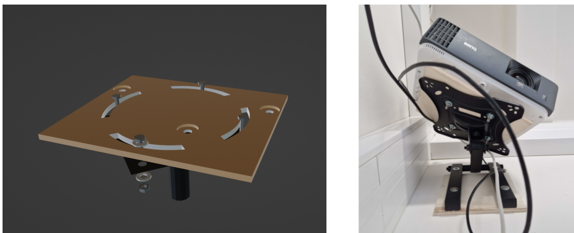
Obrázek 2.2. Vlevo model uchycení projektoru na nástavec s přidáním vertikálního stupně volnosti. Vpravo výsledné uchycení na stěnu.
