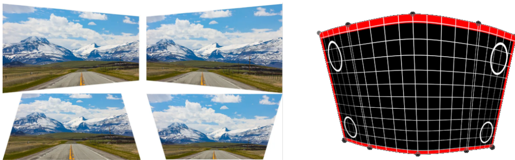
Obrázek 1.4. Vlevo různé druhy perspektivní lineární deformace pomocí funkce keystone. Vpravo nelineární perspektivní deformace pro projekci na válec.
