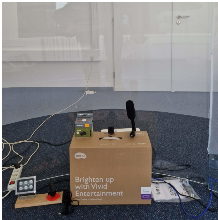
Obrázek 2.5. Umístění kamery a mikrofonu ve válci.
