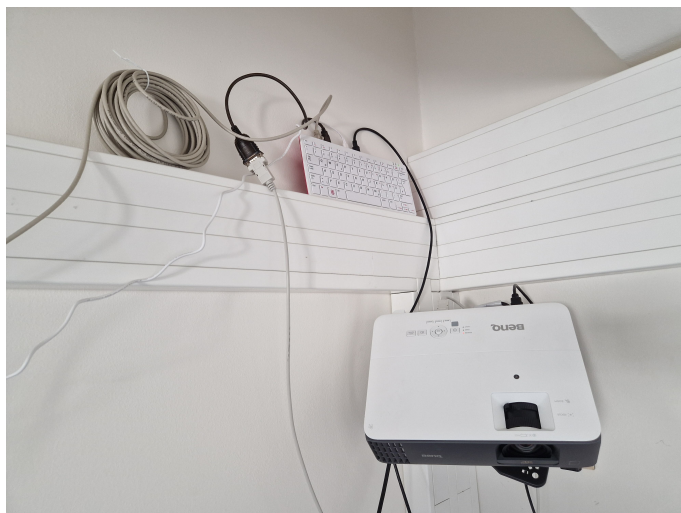
Obrázek 2.3. Kompletní projekční jednotka – projektor + minipočítač Raspberry Pi 400.
